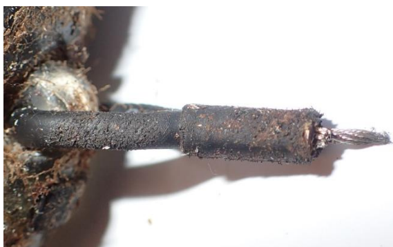
Figure 18 : Balise d'Iroise retrouvée avec son câble sectionné (E. Stéphan- APECS)
