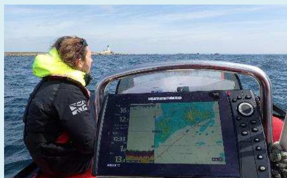
Combiné GPS cartographie mis à disposition par la société Navicom (© A. Rohr-APECS)
